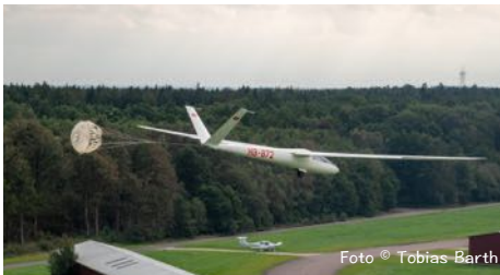
Die AN 66 HB-872 bei einer Schirmlandung; sie war jedoch auch mit Bremsklappen ausgerüstet
