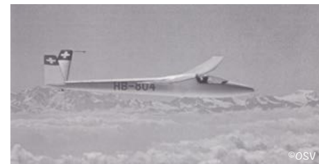
Elfe S2 mit V Leitwerk
