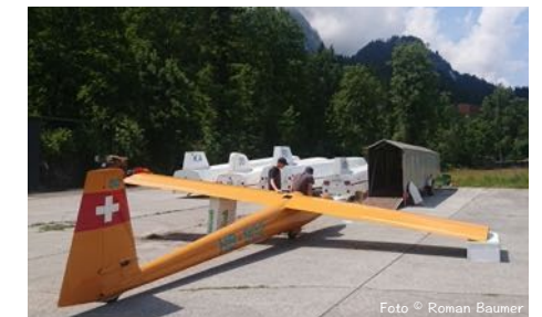
Die Elfe S3 HB - 902 beim Aufbau. Das Mittelteil ist montiert.
