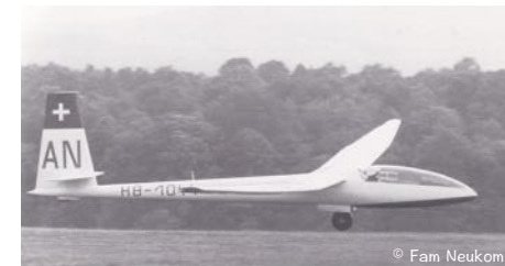
AN 66C HB-1044 mit 23 m Spannweite und variabler Flügel- fläche mittels in Flugrichtung ausfahrbarer Fowler Klappen.
