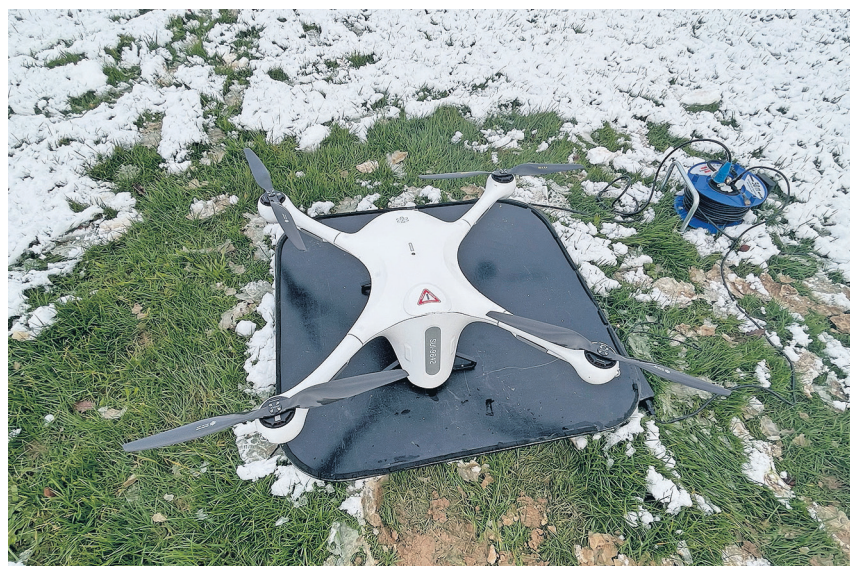
Die Drohnen können eine Ladung bis zu zwei Kilogramm transportieren.
